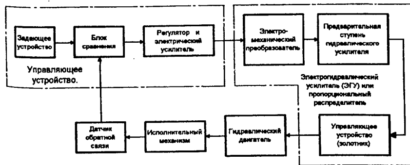
Рис. 3.63. Структурная схема следящей системы управления позиционированием
